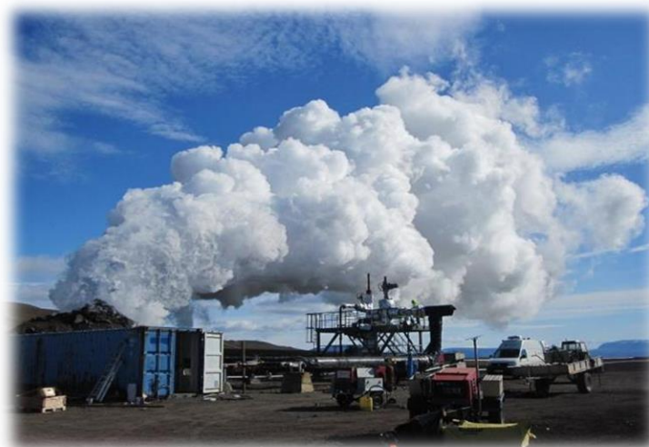
شکل (۳)- نمایی از آزمایش چاه زمین‌گرمایی IDDP-1 در منطقه کرافلا (ایسلند) با توان تولید برق ۳۶ مگاوات
